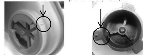
1.4.3 Работа полумаски заключается в изолировании подмасочного пространства от загрязненной атмосферы. Очищенный от загрязнений воздух, пройдя через фильтры, установленные в узлах вдоха (поз.4), попадает в органы дыхания человека. Выдыхаемый воздух проходит через узел выдоха (поз.6) и выводится в окружающую среду.
